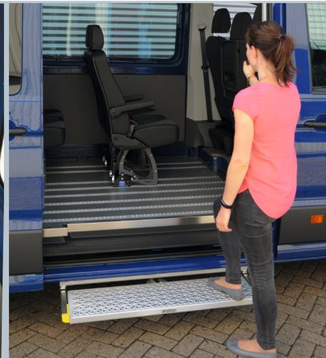
Die elektrische Trittstufe ermöglicht einen bequemen Seiteneinstieg.
